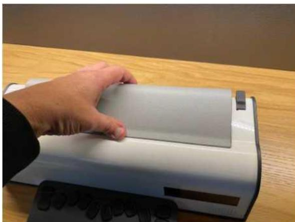
**Fig. 1** Removendo a tampa superior da Mountbatten Braille Tutor
