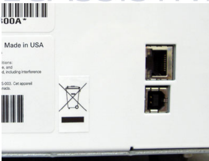
Mostra os conectores USB e LAN na parte traseira da impressora
