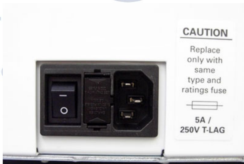
Mostra o módulo de energia na parte traseira da impressora
